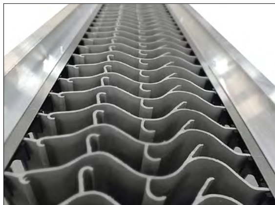
Детали каркаса каплеуловителя из профиля P120/18
