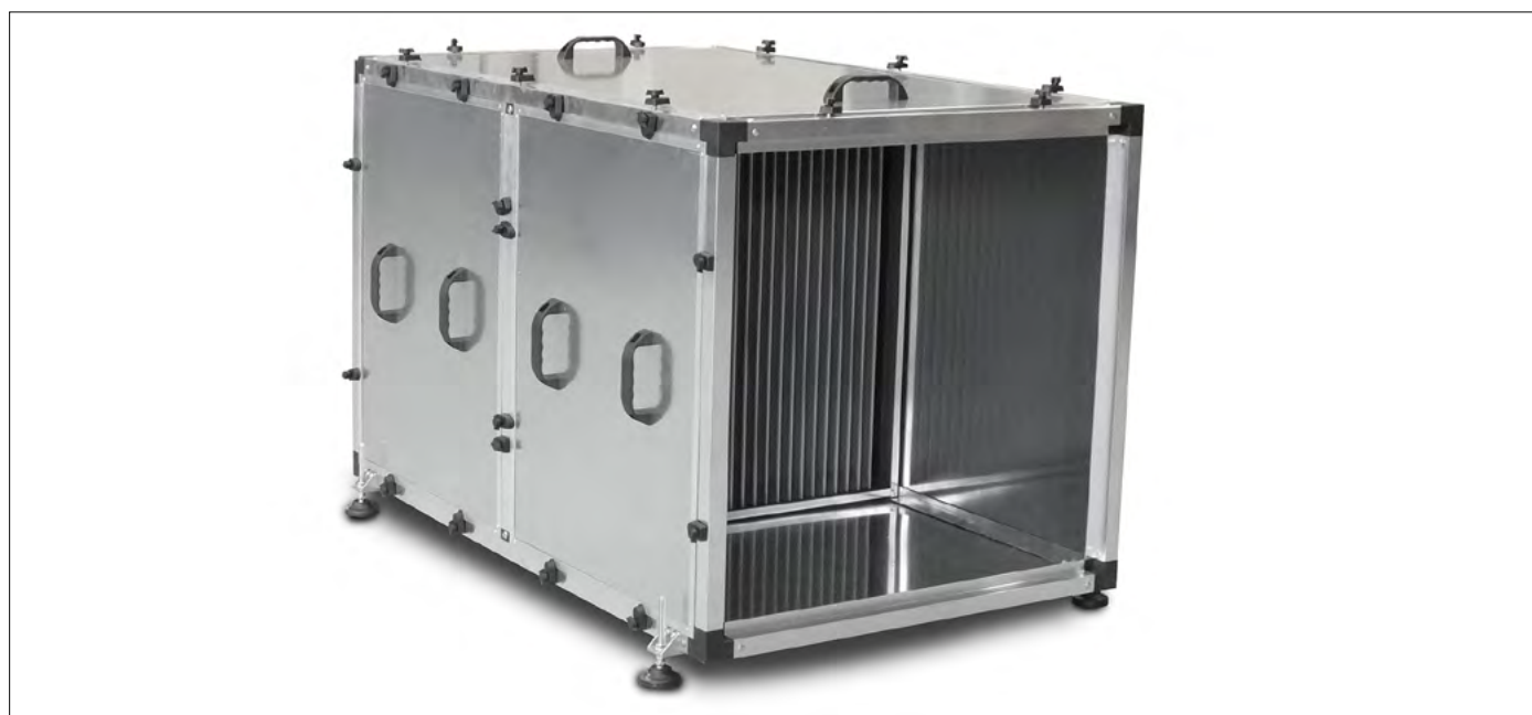
Каплеуловитель в корпусе из профиля P130/25 и сэндвич-панелей 25 мм. Корпус напольного исполнения со съемными люками и регулируемыми опорами.
