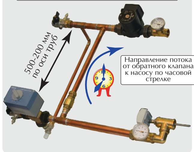
Модель 2 с П-образным байпасом левая Исполнение Р С регулированием межосевого расстояния 500-300 мм
